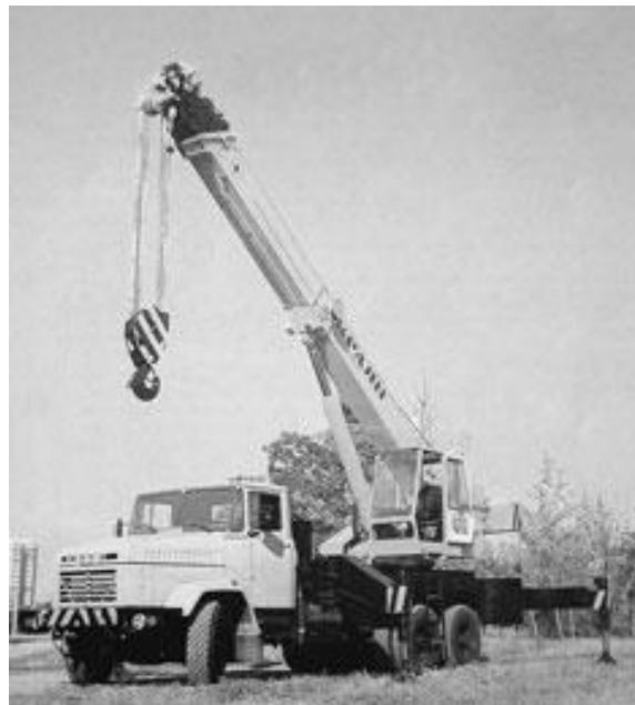
Рис. 3.11. Кран дизель-електричний на пневмоколісному ходу
