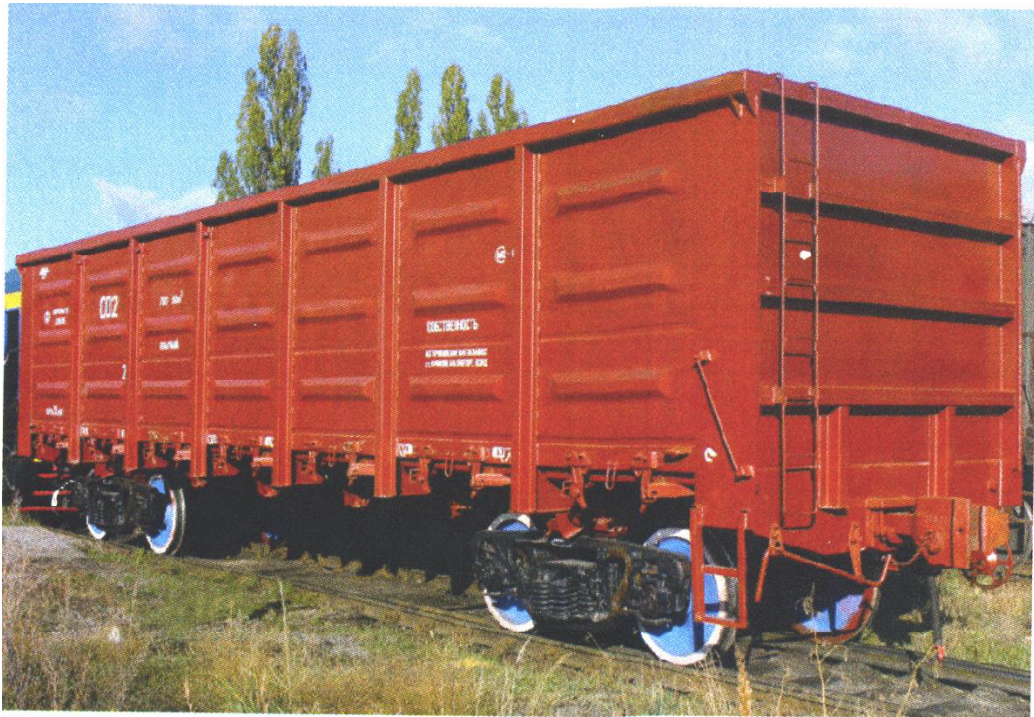
Рис. 17 Піввагон нового покоління моделі 12-7023
